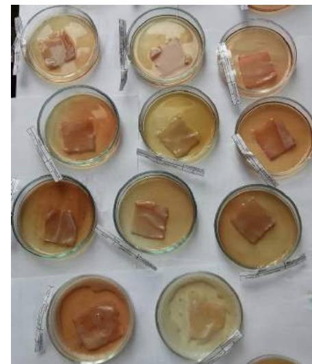
Рисунок 2.6 – Изображение исследуемых образцов ткани в чашках Петри в опыте по определению влияния добавок на способность фермента к удалению белковых загрязнений
