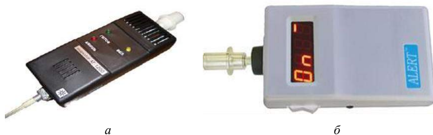
Рисунок 3.12 – Индикаторы паров этанола адсорбционного типа с полупроводниковыми датчиками [92]: а – прибор АГ-1200; б – алкометр Alert J4X
