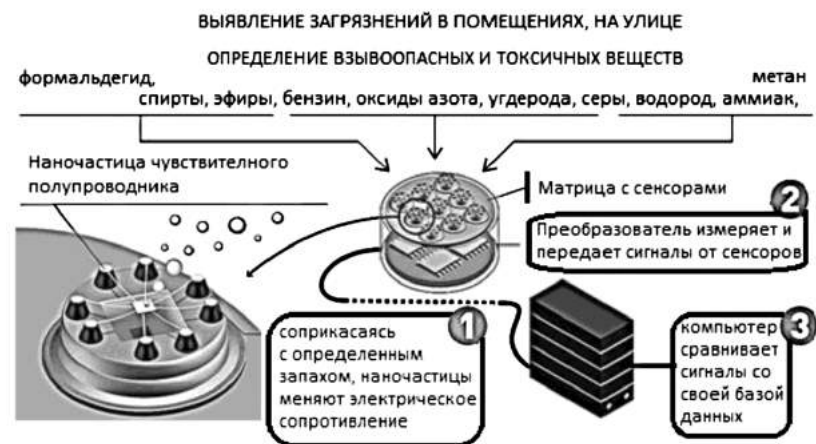
Рисунок 3.5 – Схема наносенсорной системы типа «электронный нос»
