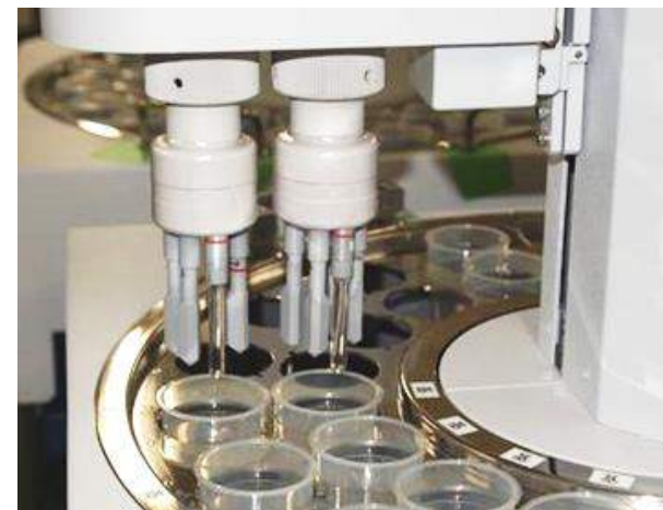
Рисунок 3.7 – Вольтамперометрическая система типа «электронный язык» с набором модифицированных электродов [83]
