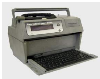
Рисунок 3.10 – Приборы для измерения концентрации паров этанола [92]: а – ИК-анализатор концентрации паров этанола АКПЭ-01; б – прибор Lion Intoxylizer-8000, оборудованный электрохимическим и ИК-сенсорами
